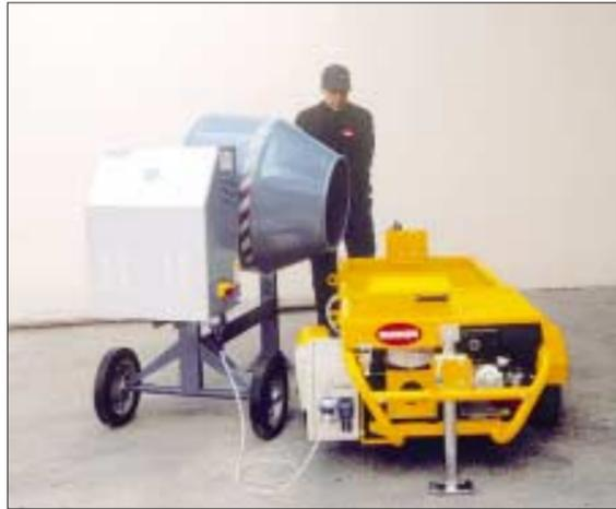
Bétonnière alimentée par la S8 SMART
