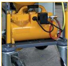
Compresseur à membrane de 250 l installé sur la version triphasée.
